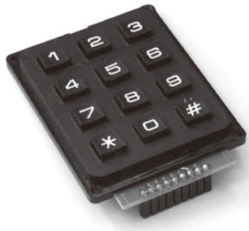
《写真8》 スイッチキーパッド にピンソケットをハ ンダ付け
