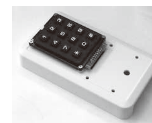
《写真12》スイッチキーパッドを取り付け
