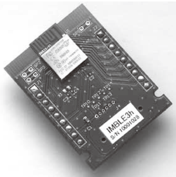
《写真7》 IMBLE3h-ADPに ピンヘッダーをハ ンダ付け
