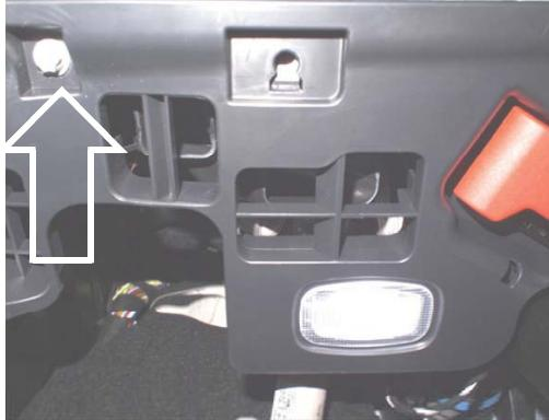
運転席アンダーカバーのボルト2本を抜き、外します。
