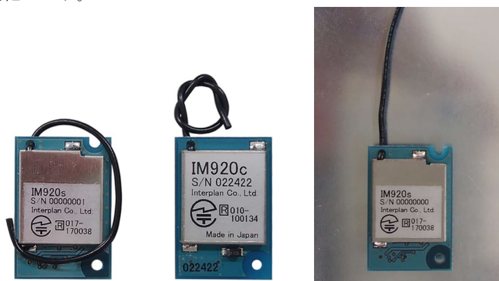
図9 良くない例 (グラウンドに接近 ワイヤアンテナが丸まっている 金属板に近い)
