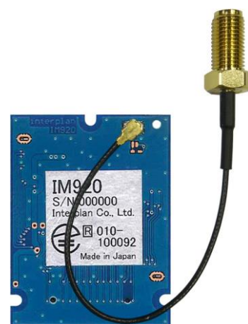
図4 接続ケーブル装着状態
